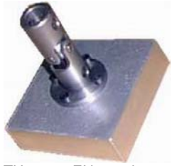
TH113-1--EN1607.jpg Zugplatten mit Gelenk für Klebeprobe
