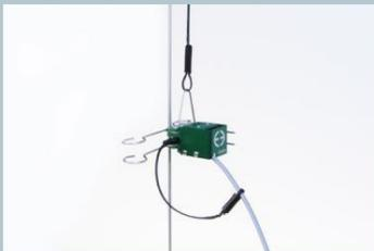
Modell 3442 mit 6,0 mm Messlänge, ±1,0 mm (±16,7 % Dehnung) Messbereich und Aufhängeband
