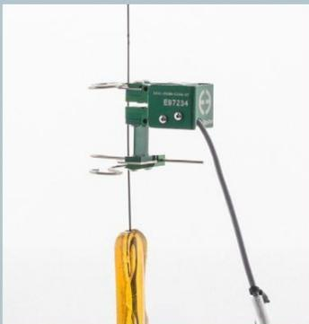
Modell 3442 mit 25-mm-Messlängenprüfkabel aus Kohlefaser
