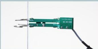
Modell 3442 mit 6,0 mm Messlänge und +5,0 mm/-1,0 mm (+83 %/-17 % Dehnung) Messbereich
