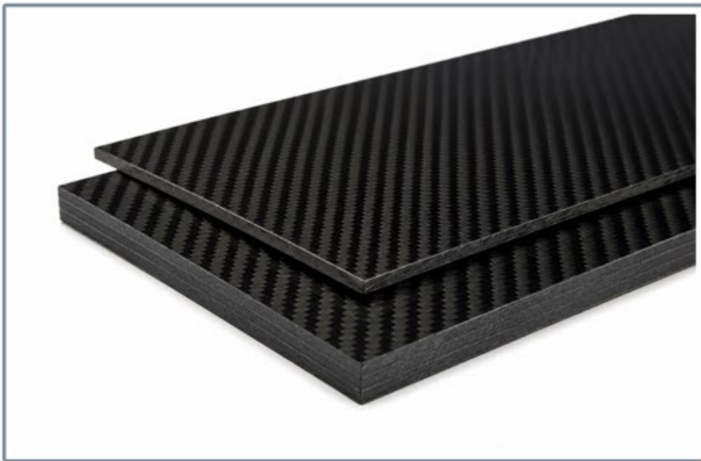
Verbundwerkstoff-Probekörper nach ASTM-D5528
