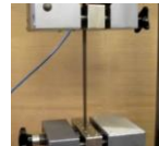
Kohlefaserprobe 20x.2 mm http://www.youtube.com/watch?v=mNFhCrRaDgU
