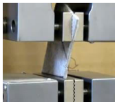
Zugversuch mit Versatz – Plane http://www.youtube.com/watch?v=GZq1XtvVmwq
