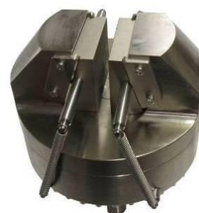
TH175-100-D260-S46 Backen mit einer Sonderöffnungsweite von 46 mm
