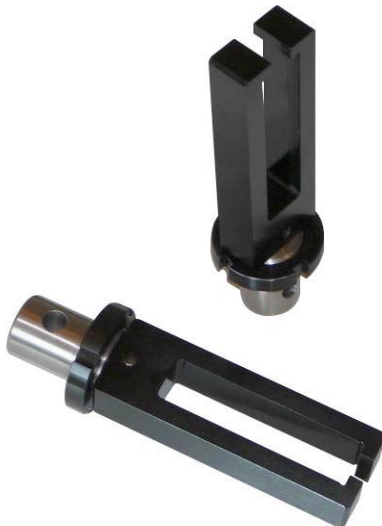
TH16-S18-Am32 gemäß ASTM D143 für Holz Small Clear Specimens of Timber
