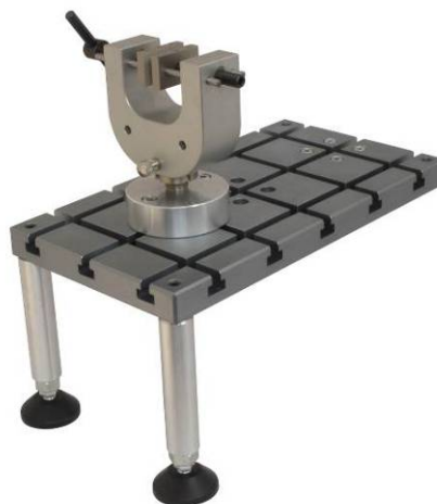
Nutzung bei einsäuliger Maschine und mit angebrachtem Spannzeug
