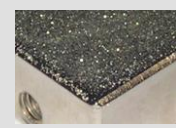
TH56g-BD Diamantbeschichtung (synthetisch)
