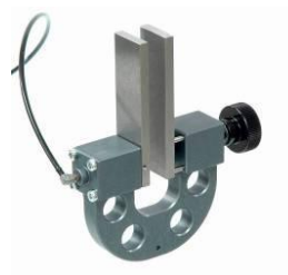
TH94 mit TH94-B100x25 Sonderbacken Blanke Backen: Höhe 100 mm x Breite 25 mm
