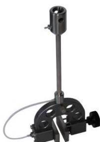
TH94-HT-B Geeignet für Temperaturkammern
