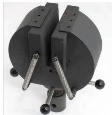
THS527-50+BP125 mit extra breiten Sonderbacken 125x100 mm
