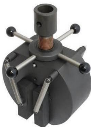
THS527-50+BP125 mit extra breiten Sonderbacken 125x100 mm
