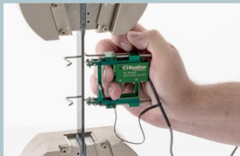
Die Quick-Attach-Funktion des Modells 3542 ermöglicht die Montage mit einer Hand
