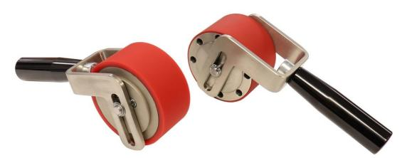
Rolle zum Anbringen der Klebeprüflinge auf die Testplatte für Abzugsversuche
