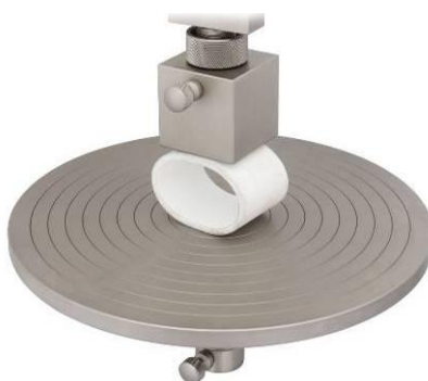
TH23-Q50-R1-Af20-St Druckversuch an Elektroinstallationsrohrsystemen gemäß EN61386-1
