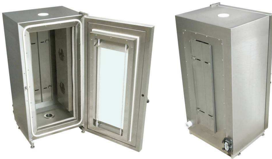
TK190-LHB Langloch auf der Rückseite für Weggeber
