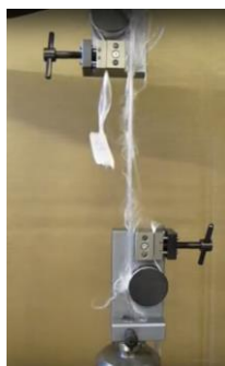
TH76-5 Zugversuch mit Glasfaser http://y2u.be/xUuzFEemRaw
