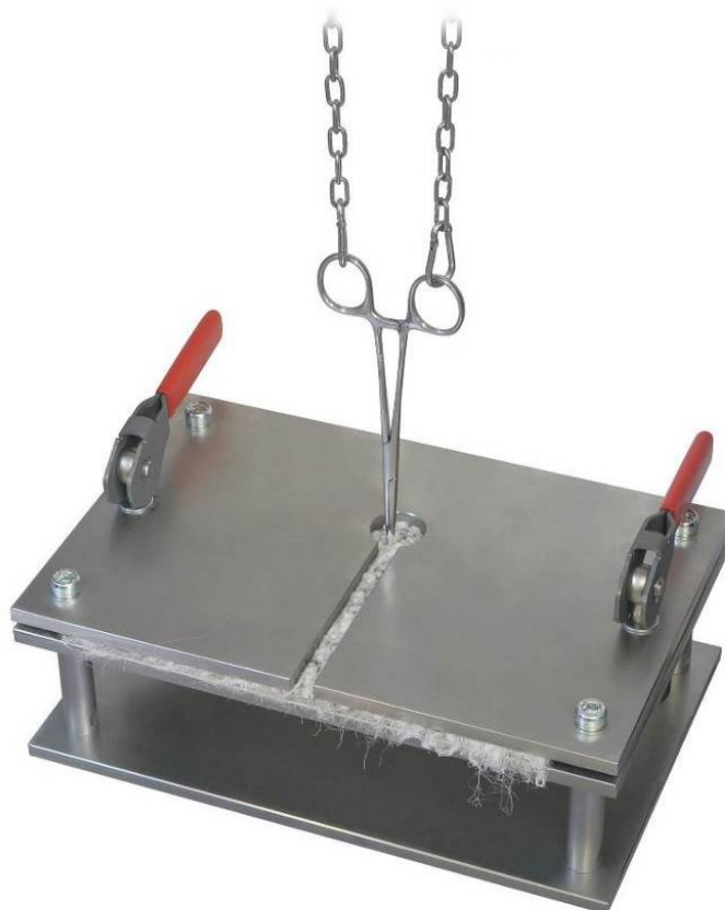
Zange zum Testen von Schnittflor-Teppichen
