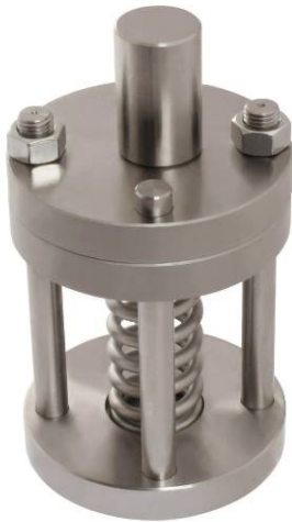
THS757-60 DVR-Vorrichtung zum Testen von Gummi gemäß ASTM-D395 Test-Methode A
